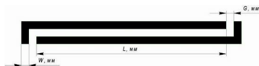
Рис. 3. Элементарная секция многосекционного встречно-штыревого конденсатора
